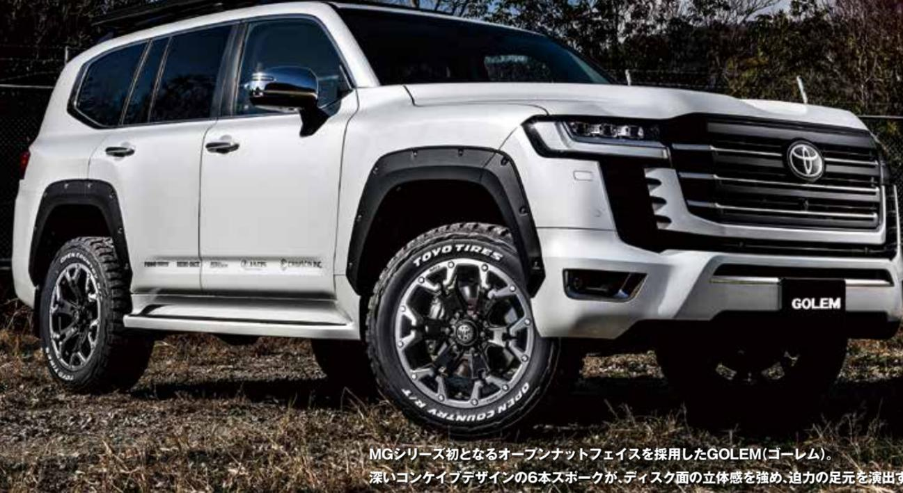
MGシリーズ初となるオープンナットフェイスを採用したGOLEM(ゴレム)。深いコンケイブデザインの6本スポークが、ディスク面の立体感を強め、迫力の足元を演出する。フローフォーミング製法により、高剛性と軽量化を両立している。
